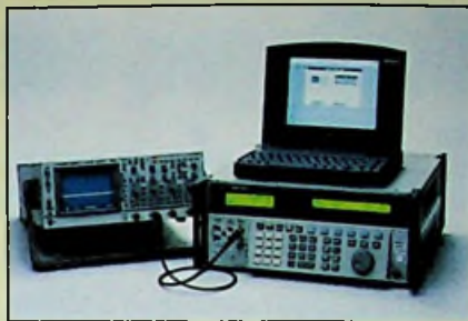
Met dezelfde kalibrator en een PC kan een oscilloscoop ook volledig automatisch gekalibreerd worden
