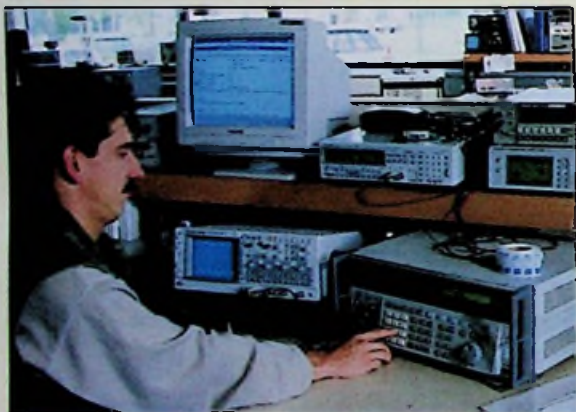
Voorbeeld van een handmatige oscilloscoop-kalibratie met een Fluke kalibrator.
